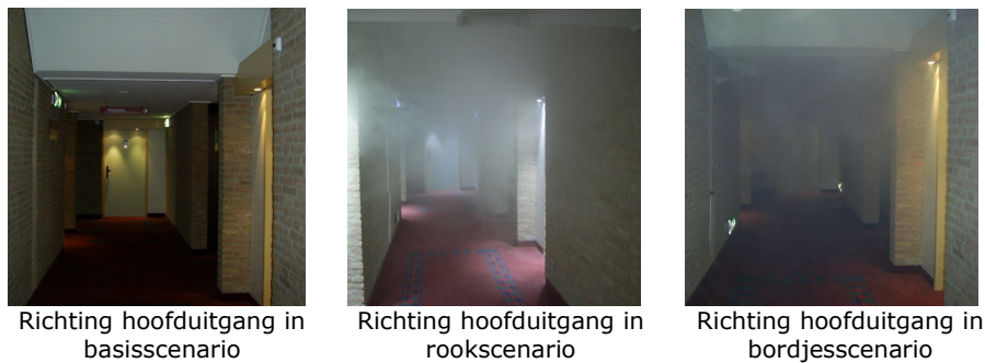
Figuur 3. Zichtbaarheid van vluchtrouteaanduidingen in verschillende condities
